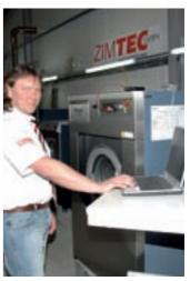
Zimtec ist auch Spezialist für die Generalüberholung von Maschinen. Nach kompletter Zerlegung bis zur Grundplatte werden alle Bauteile der Maschine gesäubert und lackiert, Verschleißteile sowie Gummidichtungen, Lagerungen und elektronische Bauteile erneuert. Nach dem Zusammenbau kommt die Maschine auf dem Prüfstand. Die Programme werden auf die entsprechenden Kundenwünsche abgestimmt, nach einigen Testläufen erfolgt die Auslieferung.
